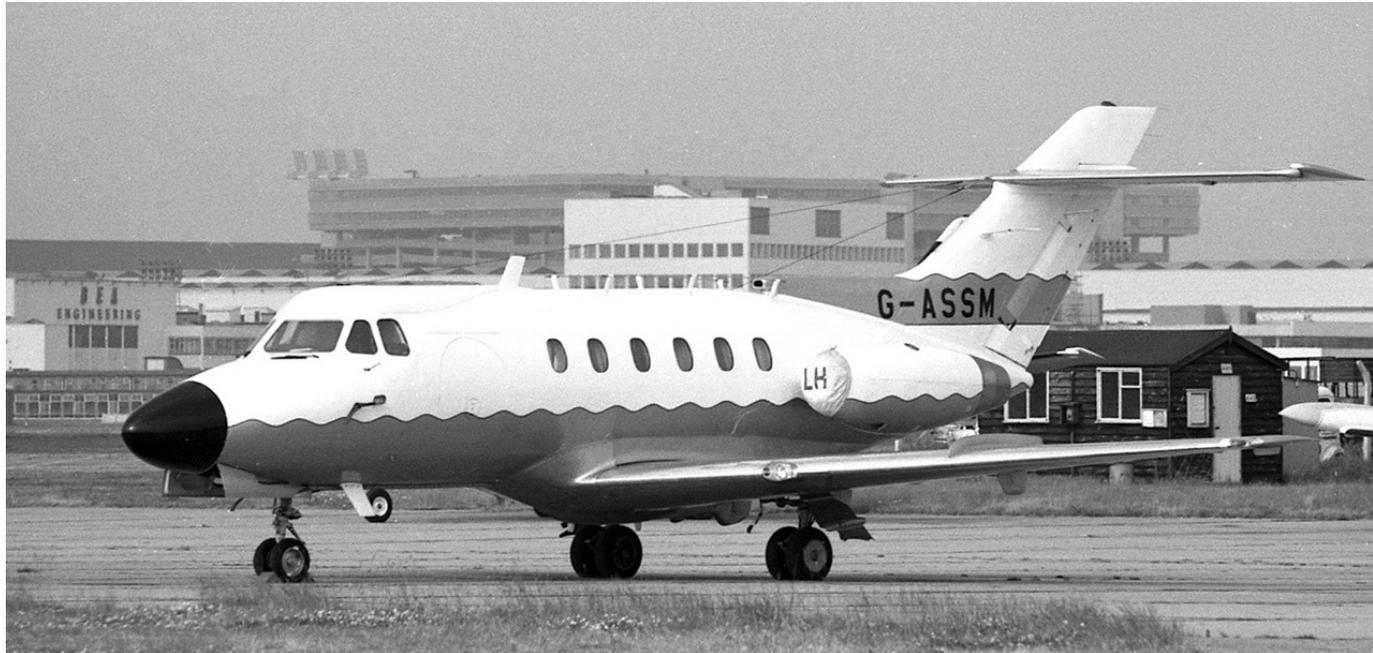
части фюзеляжа, имел крейсерскую скорость 800 км/ч и дальность полета - 2400 км.
