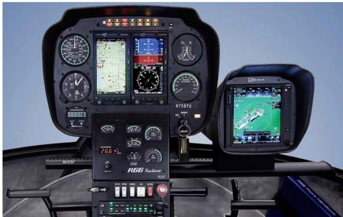
ки, так и для традиционных аналоговых приборов. Радиостанция GTR 225B теперь будет поставляться в стандартной комплектации всех вертолетов вместо Bendix/King KY 196A/197A. GTR 225B навигаторы GTN 635, 650 и 750 с функциями радиосвязи обеспечивают дискретность каналов 8.33 кГц, что соответствует современным требованиям.
