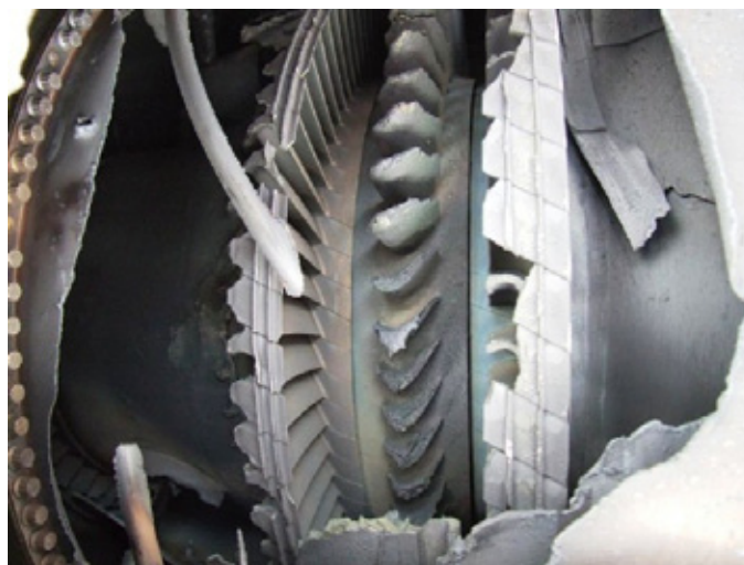
Двигатель Cessna Citation после полета в пепле.
