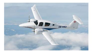
билизатор хвостового оперения. Характеристики и ценовая информация о DA62 пока не разглашаются, но известно, что самолет будет предлагаться в различных конфигурациях, до семи мест, в нескольких вариантах с максимальной взлетной массой до 2300 кг (5070 фунтов) и крейсерской скоростью выше 200 узлов.
