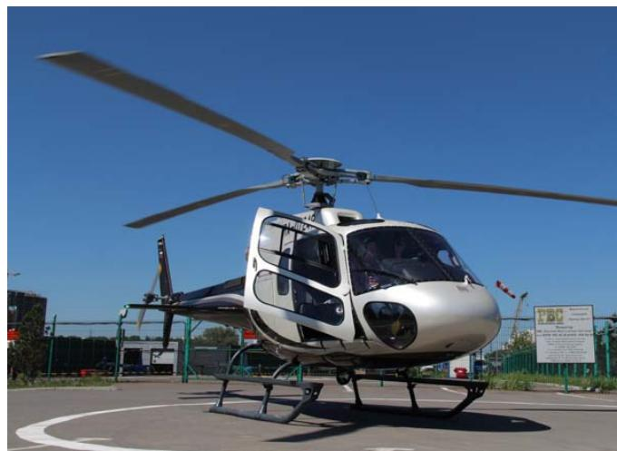
«Вертолеты оборудованы шасси полозкового типа. Это позволит выполнять посадку на неподготовленные площадки. Гарантия на вертолеты будет действовать на протяжении двух лет или тысячу часов полета с даты приемки», — передает администрация.
