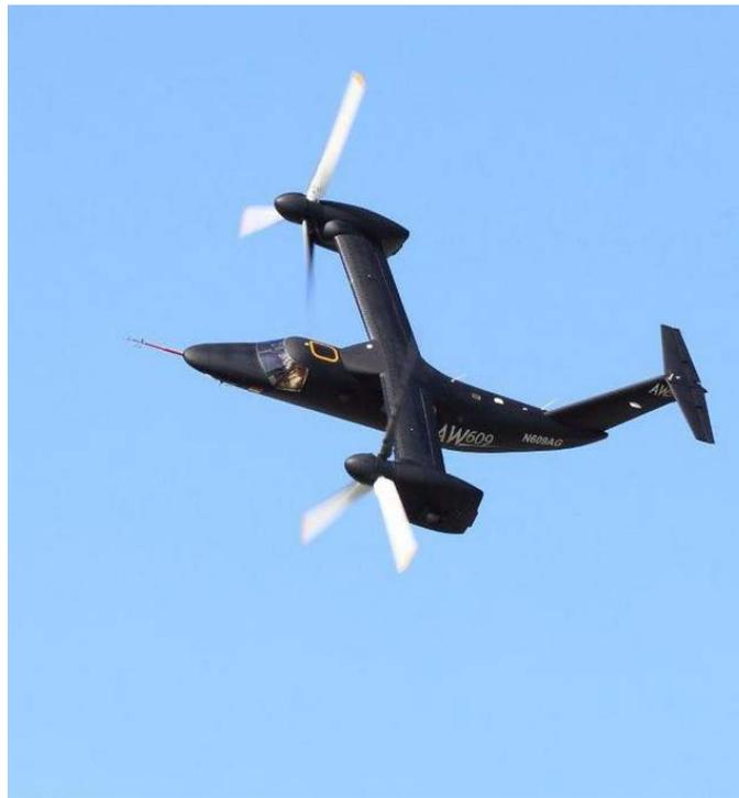
В докладе сообщается, что пилот компенсировал эти колебания, используя обычные методы управления, однако нынешний алгоритм управления конвертопланом при таких движениях ручки управления вызывает рыскание летательного аппарата для компенсации аэродинамических эффектов от винтов.
