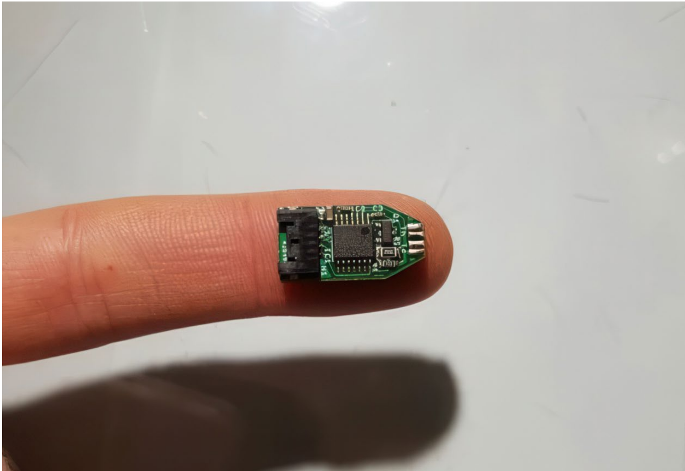
Микродатчик СТА является ключевым элементом нового зонда, который будет предоставлять пилотам более надёжные предупреждения об обледенении (Изображение: Surrey Sensors)
