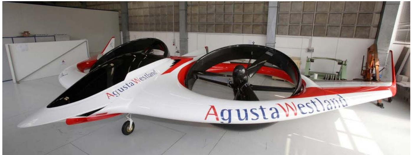
На крейсерской скорости основную подъемную силу аппарату обеспечивают крылья, внешняя часть которых является съемной. Управление по крену и тангажу осуществляется с помощью элевонов (гибрид элеронов и руля высоты), а V-образный хвост обеспечивает продольную устойчивость.
