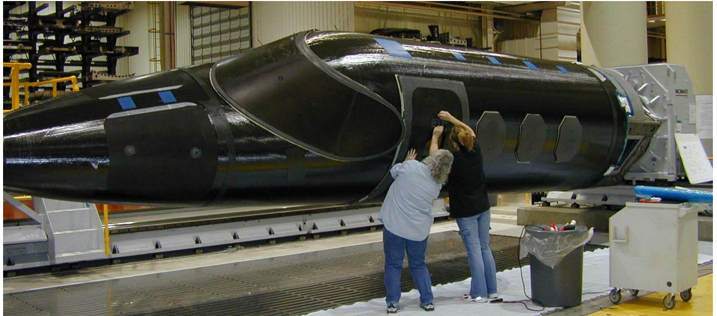
У Premier, как и у Hawker 4000, полностью композитный фюзеляж, и новый владелец получит всю технологическую оснастку
