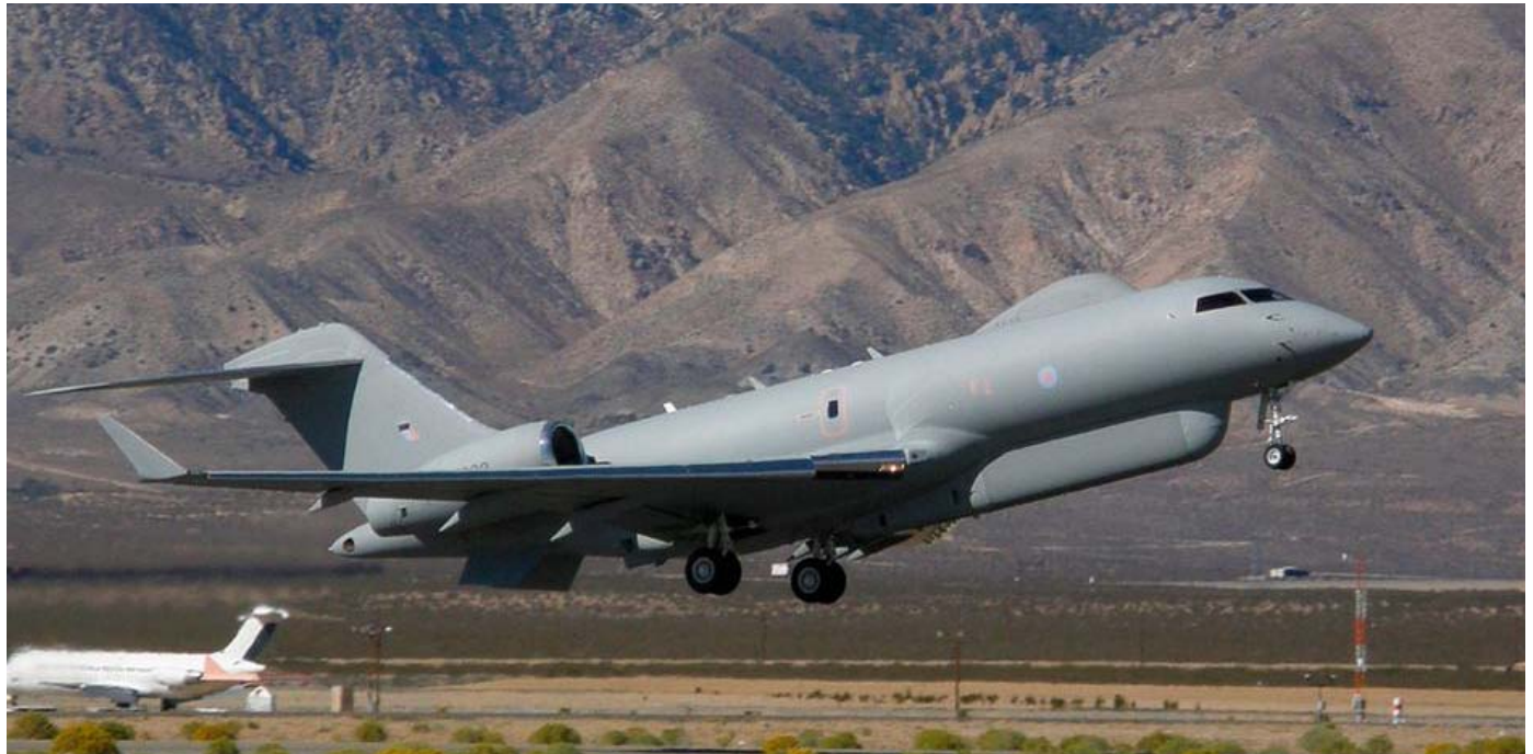
Самолет ДРЛО Raytheon Sentinel R1 британских королевских ВВС сделан на базе Global Express
