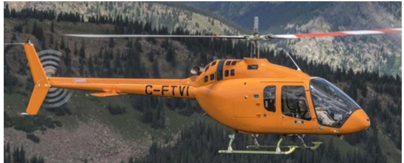
с системой FADEC, крейсерской скоростью 232 км/ч, дальностью 667 км и полезной нагрузкой 1500 кг. Вертолет спроектирован с приоритетом обеспечения безопасности, эффективности и надежности, и, по мнению компании, обладает лучшей ценой в своем классе.
