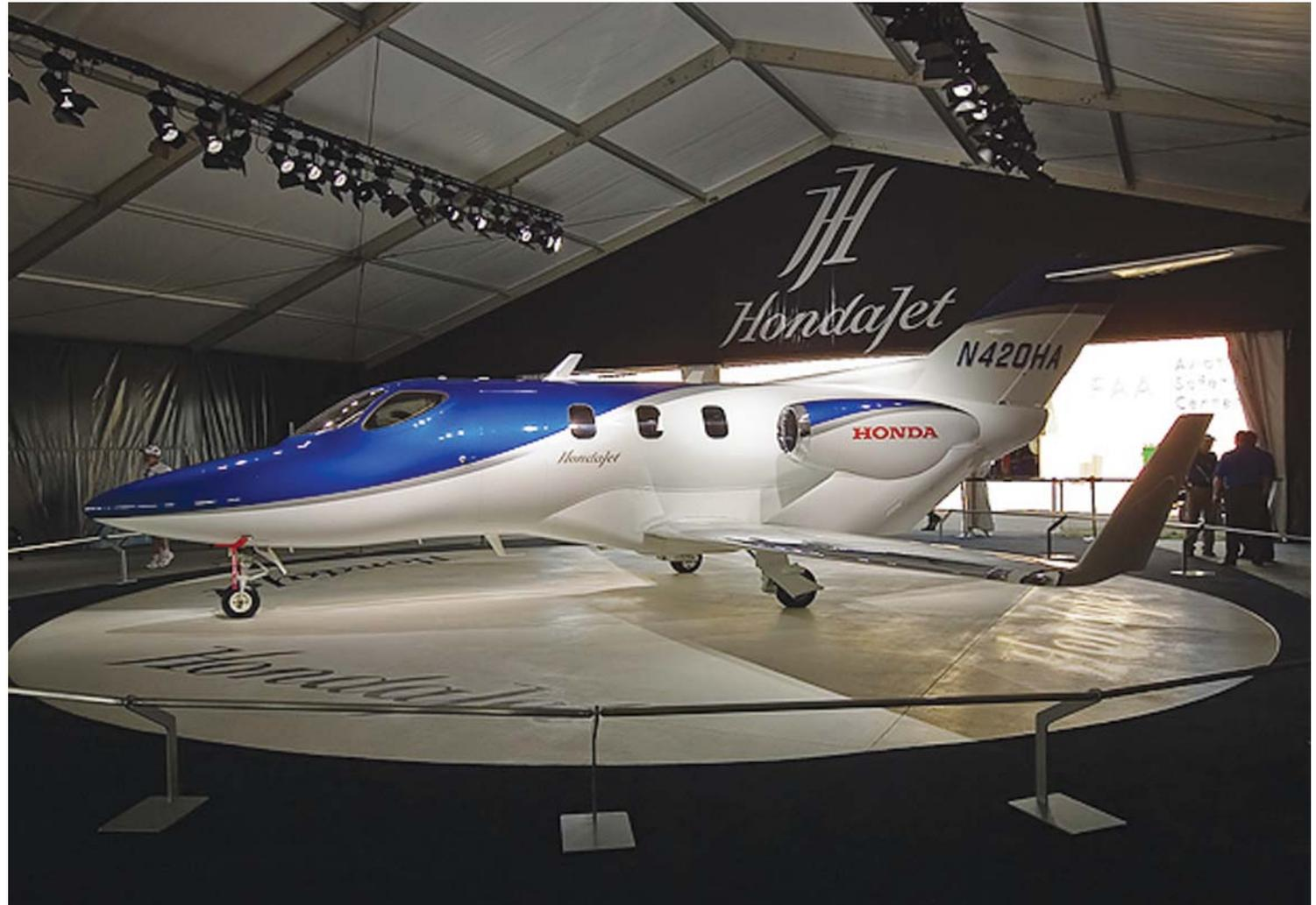
Для повышения прочности и снижения общей массы фюзеляж HondaJet полностью выполнен из углекомпонитных материалов с алюминиевыми усиливающими элементами. На вертикальных пилонах над крыльями расположились турбовентиляторные реактивные двигатели совместного производства General Electric
